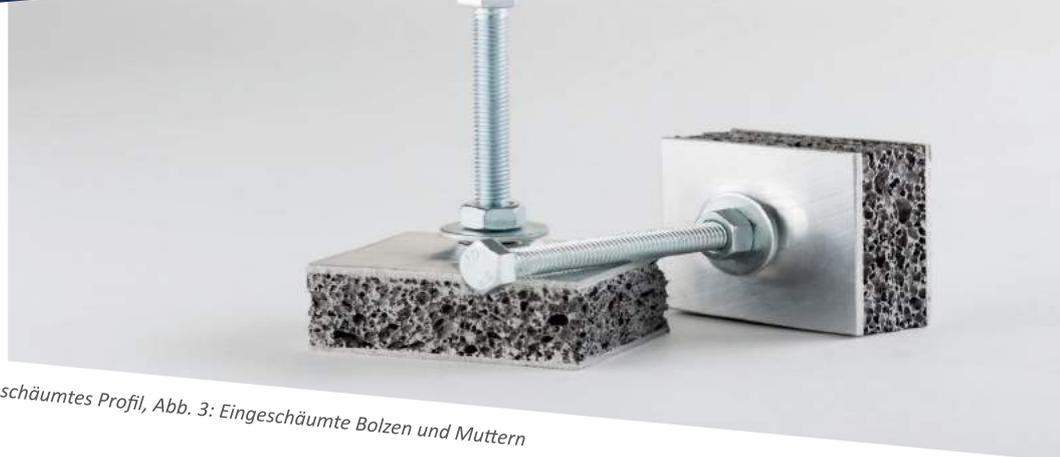
Abb. 1: Strukturdetail von Aluminiumschaum, Abb. 2: Ausgeschäumtes Profil, Abb. 3: Eingeschäumte Bolzen und Muttern
