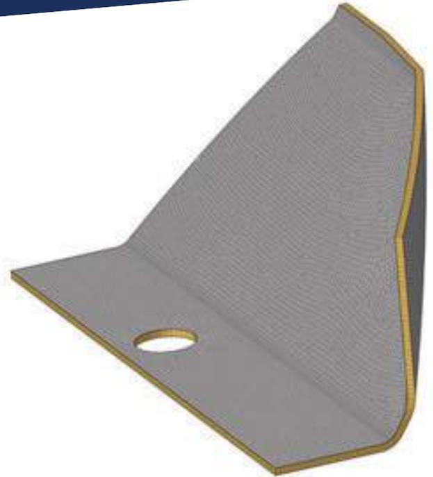
Abb. 1: FE-Modell eines Verkleidungselements als H-MSV (TGM/Compren)
